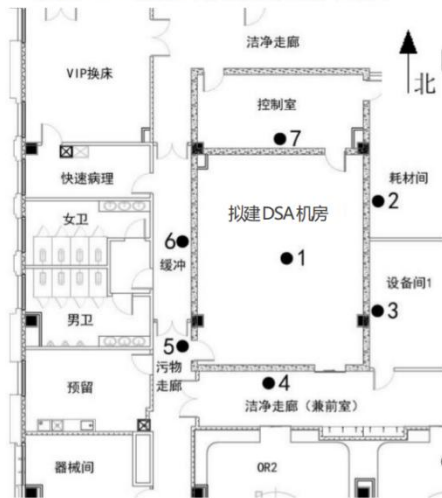
3. 拟建 DSA 机房楼上检测位点示意图
